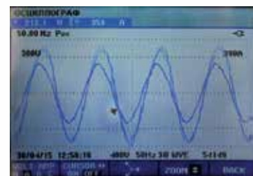
Ток и напряжение в фазе. Фильтр ВКЛЮЧЕН
