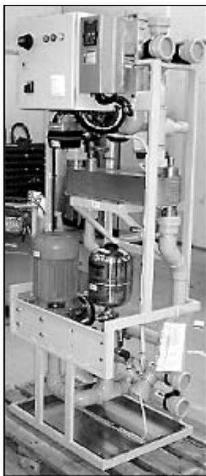
Рис. 9. Станция охлаждения, поставляемая с ПЧ Vacon NXCW (пример)
